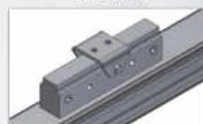
安裝浮動支架
